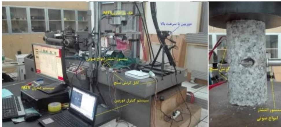
شکل ۱. تجهیزات مورد استفاده در آزمون مقاومت فشار تک محوری استاتیکی
