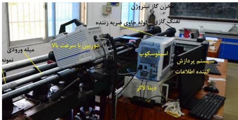
شکل ۱. تجهیزات مورد استفاده در آزمون مقاومت فشار تک محوری استاتیکی
