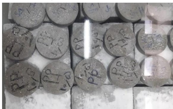
شکل ۴. نمونه‌های دیسک برزیلی آماده شده داخل استخر آب با شرایط استاندارد
