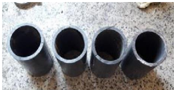
شکل ۵. لوله‌های از جنس PVC برای آماده‌سازی نمونه‌ها جهت انجام آزمایش‌های تعیین خواص فیزیکی و مکانیکی
