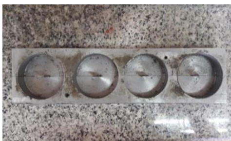
شکل ۳. قالب‌های مخصوص ساخته شده با طرح دیسک برزیلی دارای ترک مستقیم
