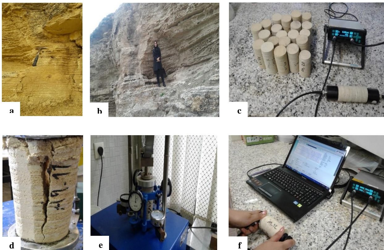
شکل ۳. (a و b) رخنمون سطحی سنگ آهک سازند آقچاگیل، (c) نمونه‌های استاندارد برای آزمون سرعت موج فشاری، (d و e)، آزمون مقاومت فشاری تک‌محوری، (f) آزمون سرعت موج برشی
