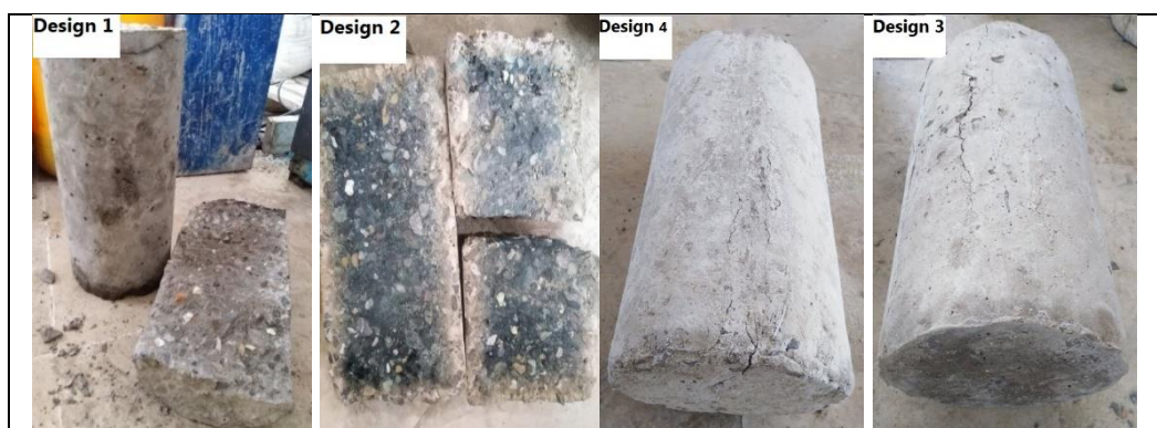
شکل ۴. نمونه بتنی پس از آزمون مقاومت کششی
