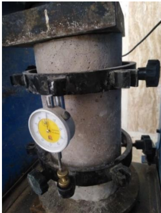
شکل ۲. نمونه بتنی در حال انجام آزمون مدول الاستیسیته
