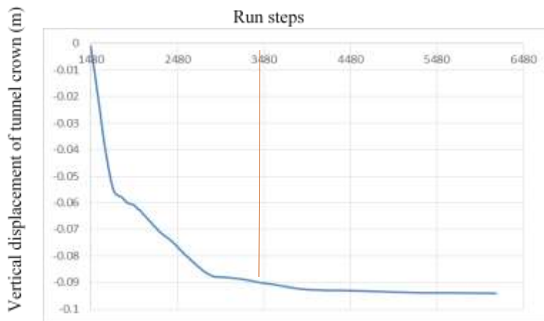
شکل ۶. جابجایی قائم تاج تونل در طول گامهای حفاری در مدل فاقد سامانه پیش تحکیمی
