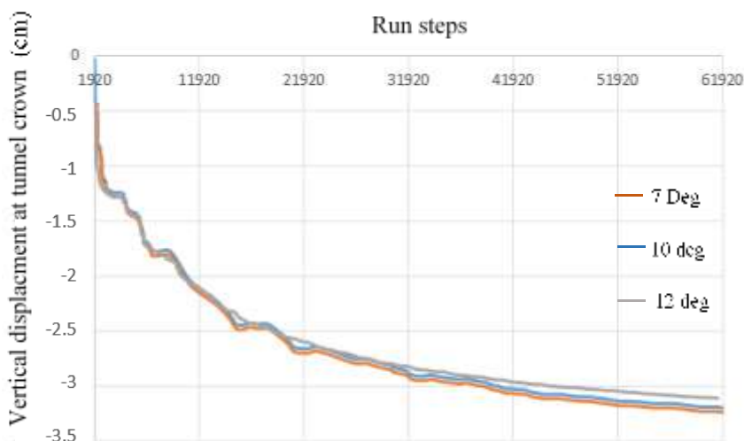
شکل ۲۰. جابجایی قائم نقطه تاج تونل در ابتدای حفاری در ۳ زاویه مختلف ۷، ۱۰ و ۱۲ درجه قرارگیری لوله ها.
