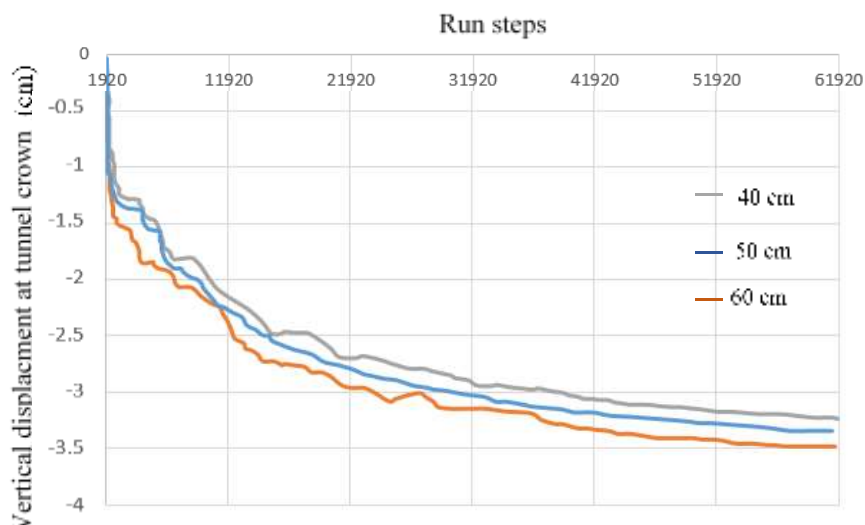
شکل ۲۱. جابجایی قائم نقطه روی تاج تونل در فاصله داری متفاوت لوله‌ها در زاویه ۱۰ درجه فرارگیری لوله‌ها.
