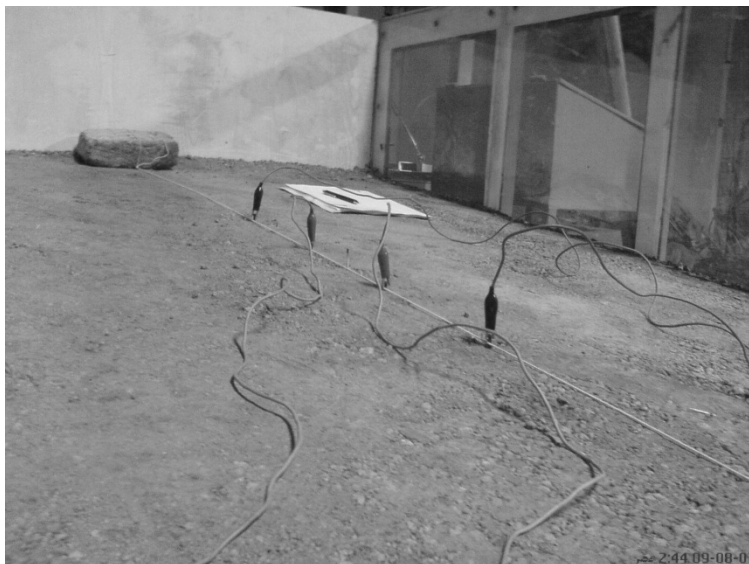
شکل ۴- تست آستانه مجاز برداشت ژئوالکتریک در تانک زمین لغزش روی لایه شاهد اولیه
