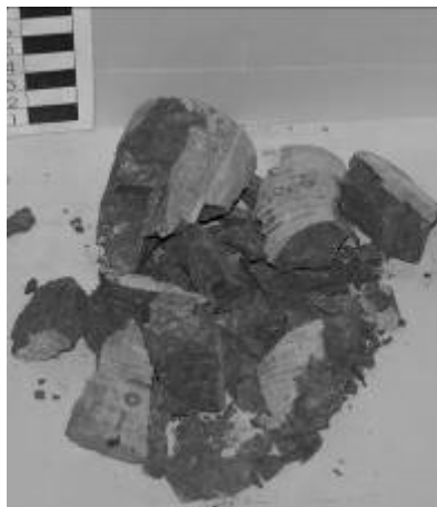
شکل ۶- شکست نوع خردشدگی شامل شکست نمونه به قطعات متعدد با ابعاد متفاوت
