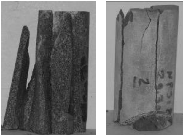
شکل ۵- گسیختگی کششی چندتایی شامل تعدادی سطح گسیختگی موازی با هم و موازی محور بارگذاری
