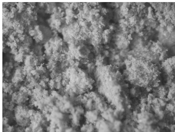
شکل ۱۲: تصویر میکروسکوپی نمونه‌ای از خاک منطقه با حالت برفکی (بزرگنمایی ۶۰۰)
