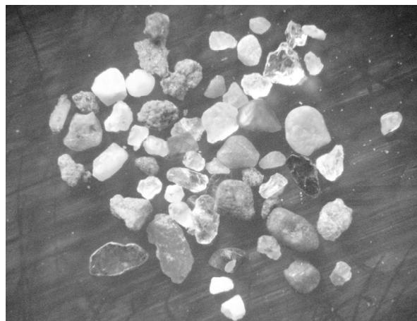
شکل ۱۳: ذرات مانده روی الک شماره ۱۰۰ با بزرگنمایی ۳۰۰
