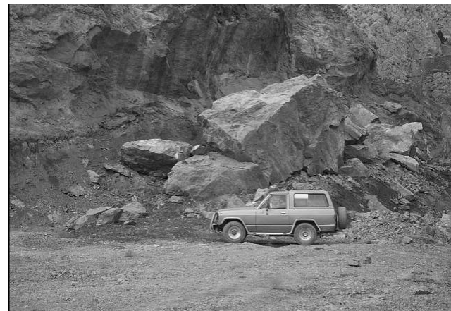
شکل ۱۶: ریزش بلوک‌های سنگی در جبهه کار معدن زو ۲
