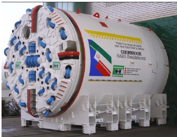
شکل ۲- کله حفار و سپر فولادی در TBM استفاده شده در تونل انتقال آب کرج- تهران
