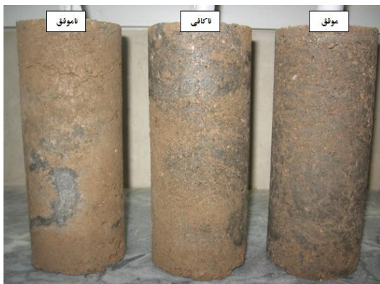
شکل ۷. شمای نتیجه تزریق سه نمونه: موفق، ناکافی، ناموفق
