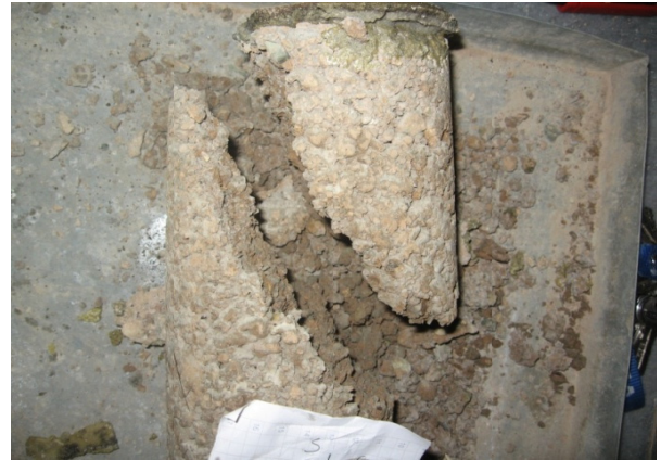
شکل ۱۳. یک نمونه شکسته شده با زاویه تقریباً ۴۵ درجه
