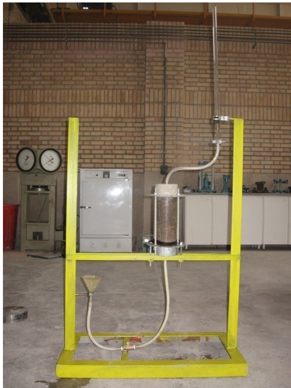
شکل ۱۹. نمونه خاک تزریق شده تحت آزمایش نفوذپذیری با هد متغیر
