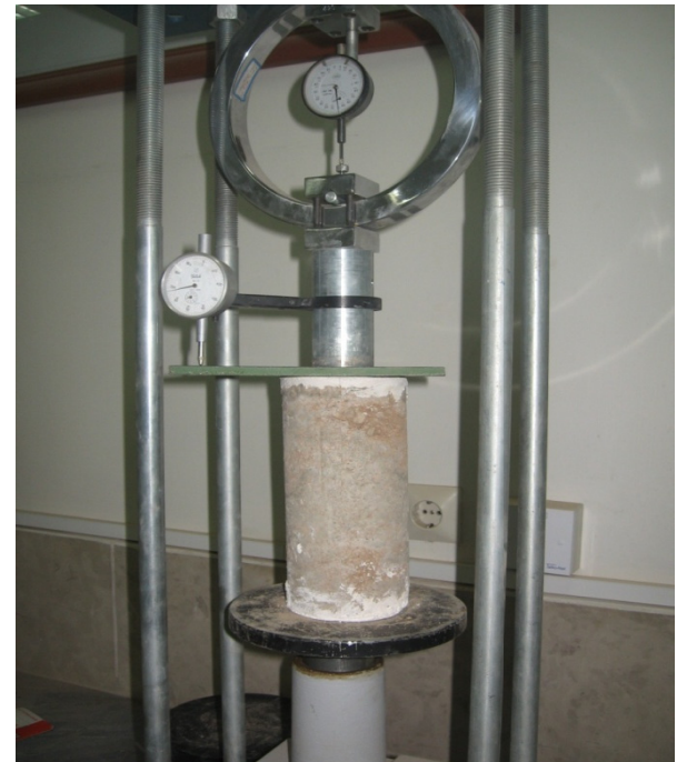
شکل ۱۲. یک نمونه سرپوش گذاری شده آماده برای شکستن
