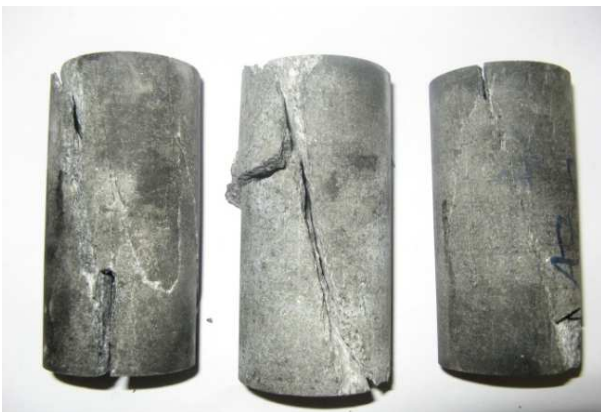
شکل ۶. نمونه‌های دیوریتی Az_2 بعد از آزمایش سه محوره
