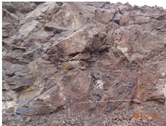
شکل ۳. نمایی از خط پیمایش پیاده شده بر روی توده‌سنگ‌های معدن چغارت، راست) ماده معدنی، چپ) باطله
