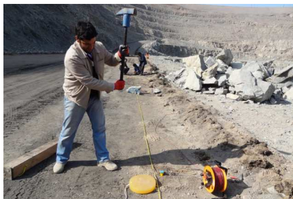
شکل ۶. نمایی از پروفیل لرزه‌ای اجرا شده جهت ایجاد و ثبت امواج طولی در معدن چغارت
