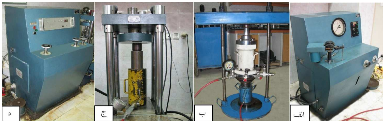
شکل ۴. دستگاه انجام آزمایش شکست هیدرولیکی، (الف) دستگاه تامین کننده فشار جانبی اعمال شده بر روی نمونه‌ها، (ب) سل سه محوری مورد استفاده همراه با جک ۲۰ تنی اعمال بار محوری، (ج) جک ۱۰۰ تنی جهت تزریق سیال به درون نمونه، (د) دستگاه مورد استفاده جهت اعمال نیرو به جک ۱۰۰ تنی
