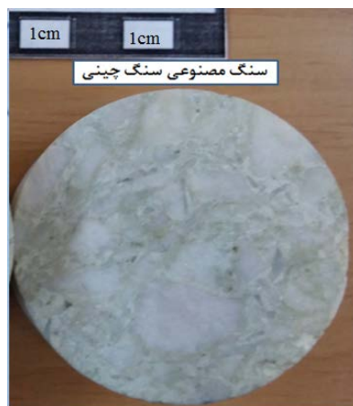
شکل ۹. نمونه سنگ‌های مصنوعی ساخته شده با سنگ‌دانه سنگ چینی با فشار و خلاء مورد نظر.
