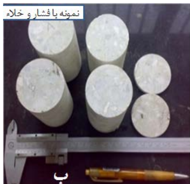
شکل ۸. دو نوع سنگ مصنوعی ساخته شده از سنگ دانه سنگ چینی با یک طرح اختلاط.
