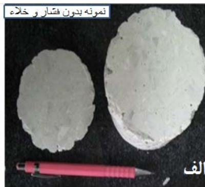
شکل ۸. دو نوع سنگ مصنوعی ساخته شده از سنگ دانه سنگ چینی با یک طرح اختلاط.
