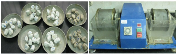
شکل ۵. دستگاه دوام و ارتگی و نمونه‌های تهیه شده از سنگ مصنوعی و سنگ طبیعی شامل تراورتن و سنگ چینی.
