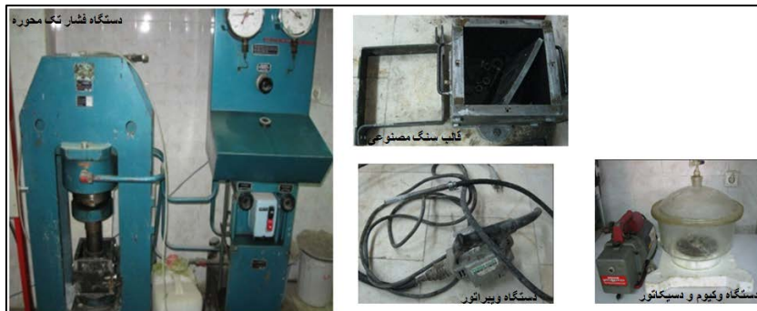
شکل ۲. دستگاه‌های موجود در آزمایشگاه در تهیه سنگ مصنوعی و قالب مکعبی ساخته شده.
