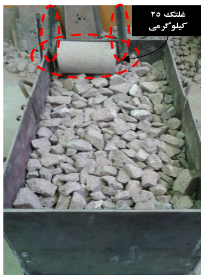
شکل ۴. نحوه‌ی غلتک‌زنی و تراکم لایه‌ها (روش تهیه نمونه‌ها)
