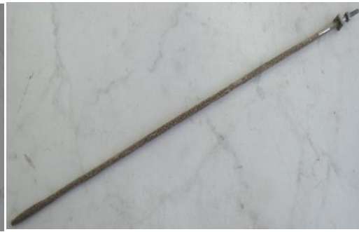
شکل ۲. میخ به طول ۳۰ cm و قطر نهایی ۴ mm استفاده شده در مدل سازی به همراه مهره و واشر که بعنوان صفحه باربر در نظر گرفته شده است.
