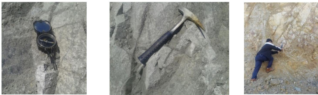
شکل ۵. تصویری انجام عملیات درزه‌نگاری در محدوده‌ی معدن
