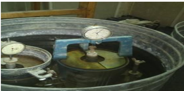
شکل ۸. طریقه اندازه گیری تورم نمونه های CBR
