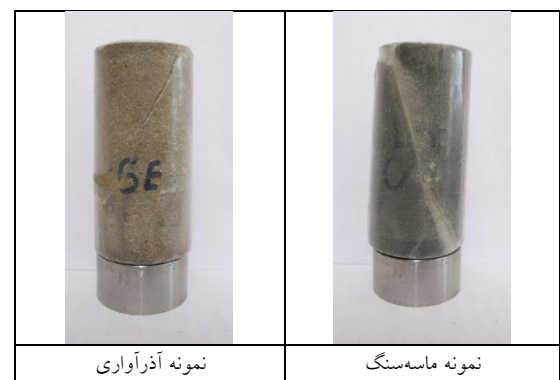
شکل ۱۰. نمونه‌های شکسته شده تحت آزمون سه محوری
