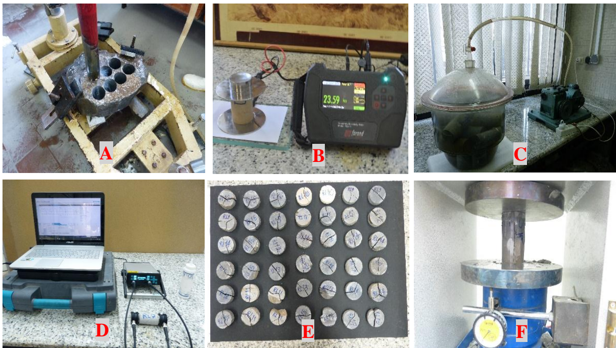
شکل ۲. مراحل انجام آزمایش‌ها. تهیه مغزه‌های استوانه‌ای شکل (A)، تعیین مقاومت الکتریکی نمونه‌ها (B)، اشباع نمونه‌ها تحت شرایط خلا (C)، تعیین سرعت امواج فراصوتی (D)، تعدادی از نمونه‌های شکسته شده در آزمایش بار نقطه‌ای (E)، آزمایش مقاومت فشاری تک‌محوری (F).
