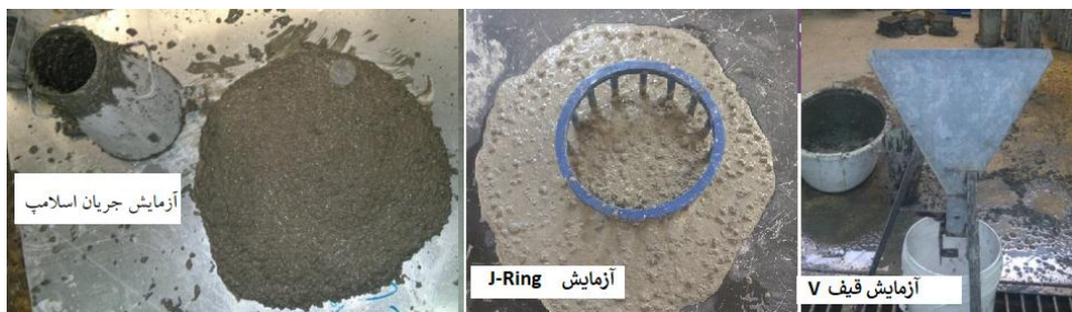
شکل ۲. تصاویر آزمایشگاهی از تعیین مشخصات روانی طرح مخلوط‌های ساخته شده
