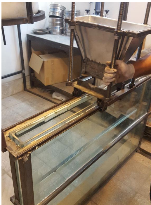
شکل ۴. تصویری از مخزن خاک و دستگاه بارش
