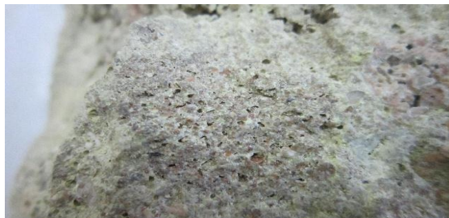
شکل ۱۲ نفوذ سیمان گوگردی در حفرات موجود در سنگدانه لوماسل.
