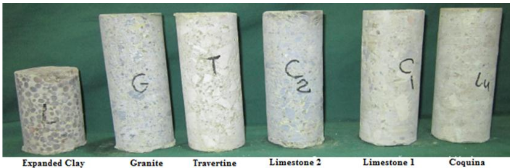
شکل ۹. مغزه‌های تهیه شده از بتن‌های گوگردی.
