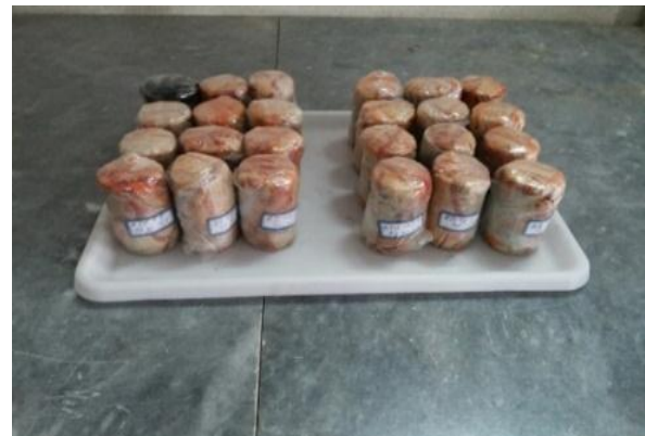
شکل ۹. شرایط عمل آوری نمونه‌ها با پوشش‌های مرطوب و عایق
