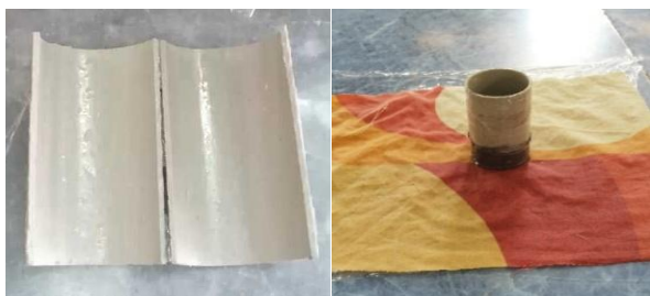
شکل ۶. قالب‌های PVC جهت ساخت نمونه
