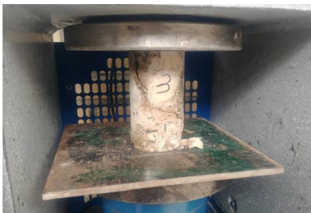
شکل ۶- شکست نمونه در آزمایش بارگذاری نقطه ای و آزمون مقاومت فشاری تک محوری
