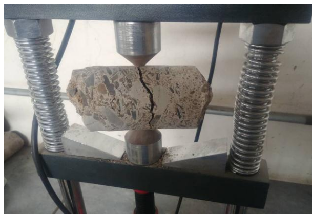
شکل ۶- شکست نمونه در آزمایش بارگذاری نقطه ای و آزمون مقاومت فشاری تک محوری
