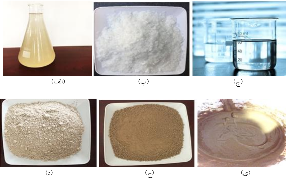
شکل ۲. مواد مورد استفاده در تهیه ژئوپلیمر مورد استفاده در این مطالعه؛ (سیلیکات سدیم) (الف)، سدیم هیدروکسید (ب)، آب (ج)، متاکائولن (د)؛ خاک لس (ح)؛ و مخلوط نهایی حاصل از ترکیب مواد (ی)
