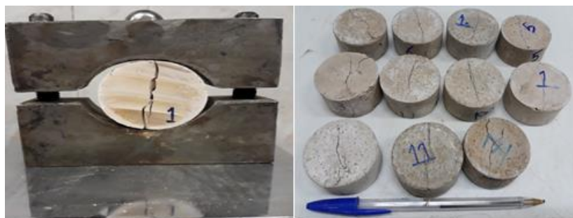
شکل ۹. نمونه‌های گسیخته شده در آزمایش مقاومت کششی روی نمونه‌های لس مورد مطالعه
