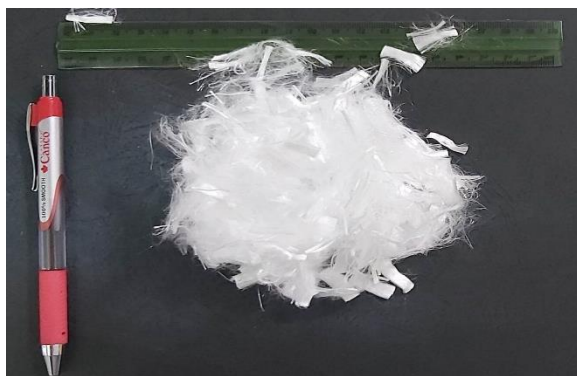
شکل ۲. الیاف پلی پروپیلن تهیه شده از کارخانه با طول تقریبی ۱۲ میلیمتر
