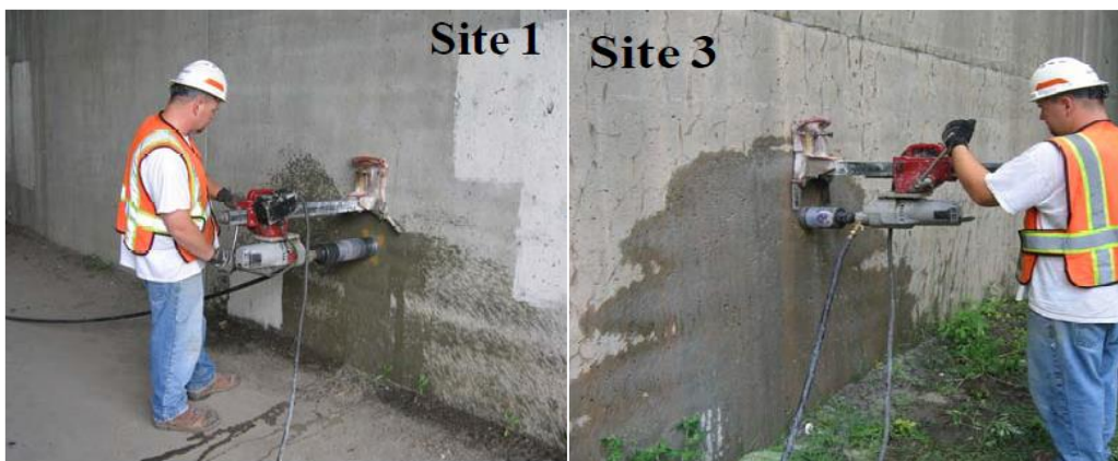
شکل ۱. ارتباط بین ظاهر بتن و مقادیر DRI، مقادیر DRI در سایت سوم تقریباً چهار برابر سایت یک بدست آمد (برگرفته از
