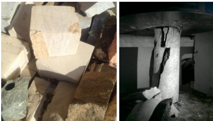
شکل ۴. تصاویری برخی از بلوک‌های جمع‌آوری شده و آزمایش مقاومت فشاری تک محوری.
