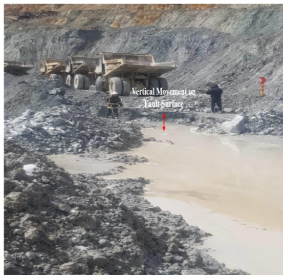
شکل ۱۳. تجمع آبهای سطحی بر روی بخش فروافتاده پله و تشدید حرکت آن
