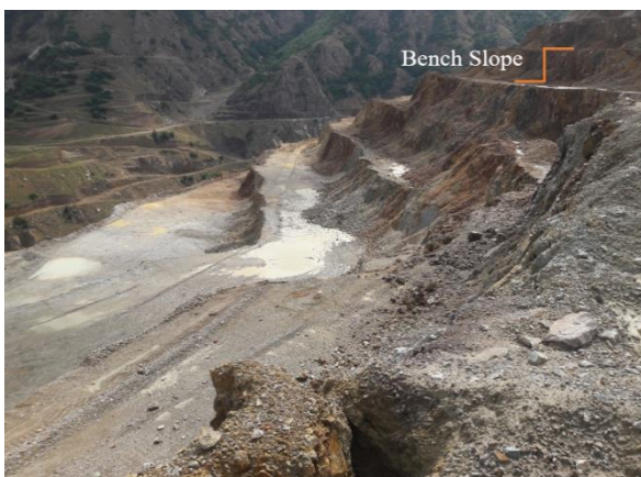
شکل ۱۶. زاویه شیب پله‌های استخراجی معدن مس سونگون در مصالح مختلف، ایجاد پله‌هایی با شیب زیادتر از حد طراحی در
