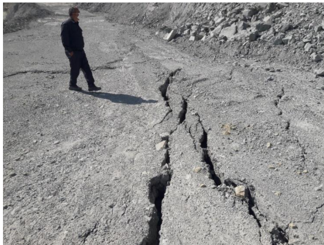
شکل ۶. ترکهای کششی مربوط به لغزش سنگهای دگرسان شده در تراز ۲۱۰۰ (دید عکس به سمت جنوب)
