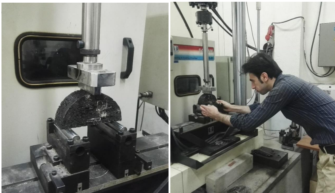
شکل ۵. دستگاه آزمایش خمش نیم‌دایره و نحوه قرارگیری نمونه زیر دستگاه
