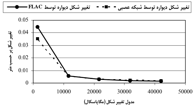
شکل ۳- مقایسه نتایج تغییر شکل دیواره حاصل از شبکه و FLAC با تغییرات مدول تغییر شکل
