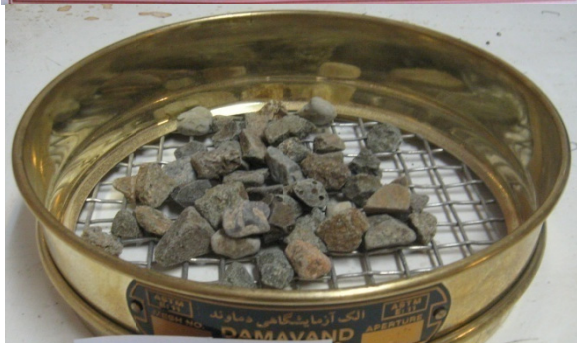
شکل ۳. عکس دانه‌های باقیمانده روی الک ۰/۵ اینچ، موقعیت: میدان تجریش.
