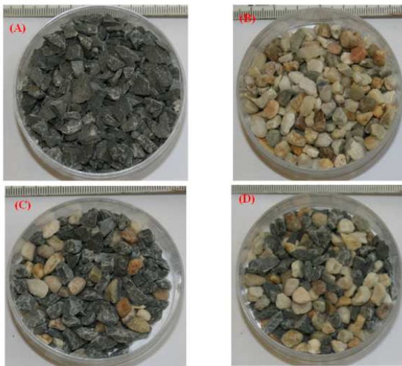
شکل ۱۰. نمونه‌های آزمایشی با دانه‌بندی ۶/۳-۴ میلی‌متر (A) سنگ آهک (B) کوارتز (C) مخلوط کوارتز ۳۰ درصد (D) مخلوط کوارتز ۵۰ درصد
