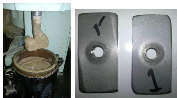
شکل ۱۳. بررسی تأثیر وجود آب در آزمایش LCPC (۱) قطعه سایشی در حالت خشک و (۲) در حالت اشباع
