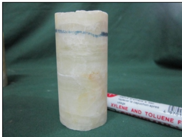
شکل ۲. تراورتن انیکس سبز در چرخه ۵۵ تبلور نمک (سمت راست) و تراورتن لیمویی در چرخه ۴۵ آزمایش تبلور نمک (سمت چپ)
