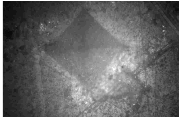
شکل ۵. تشکیل حفره منظم برای نیروی ۱۰۰۰g در سطح سنگ مرمر هرسین
