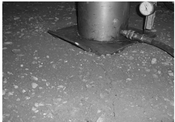
شکل ۷. آزمایش PLT بر روی خاک بدون خرده لاستیک
