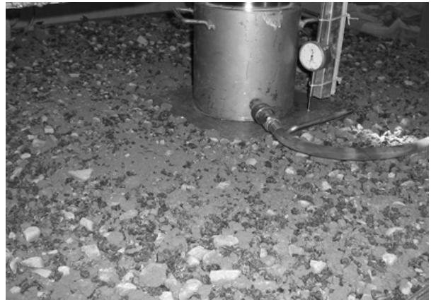
شکل ۶. آزمایش PLT بر روی خاک مخلوط با ۱۰٪ خرده لاستیک
