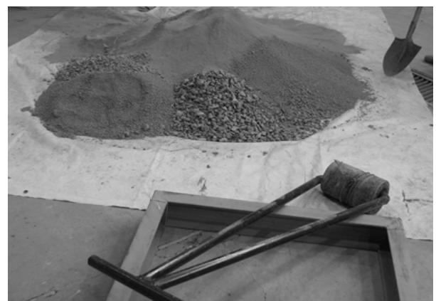
شکل ۴. خاک‌های مورد نیاز جهت ساختن نمونه GW-GC
