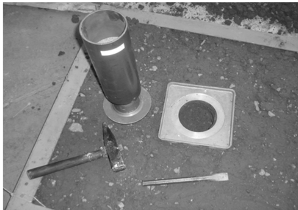
شکل ۵. آزمایش دانسیته درمحل جهت تعیین تعداد دفعات بور غلتک
