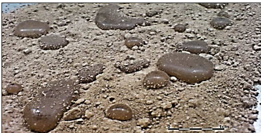
شکل ۴. عدم اختلاط آسان آب با نمونه‌های SM آلوده به مواد نفتی
