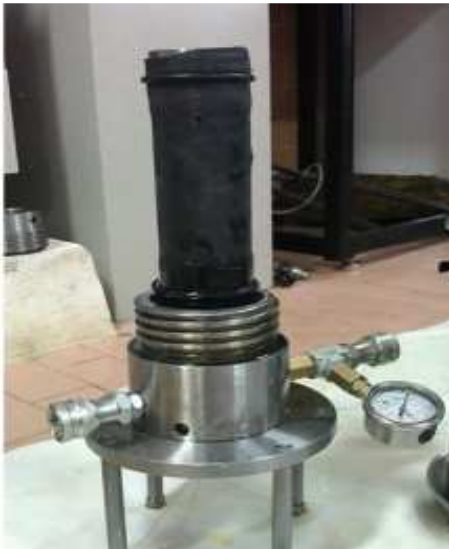
شکل ۹. نمونه نصب شده در سلول
