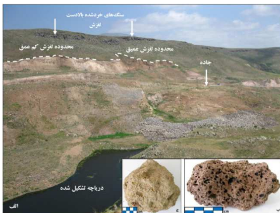
شکل ۳. الف) نمای از لغزش (نگاه به سمت شمال)، ب) توف پومیزی شده، ج) توف لیتیک دگرسان شده که به شدت سست بوده و اجزای آن به راحتی جدا می‌شوند.
