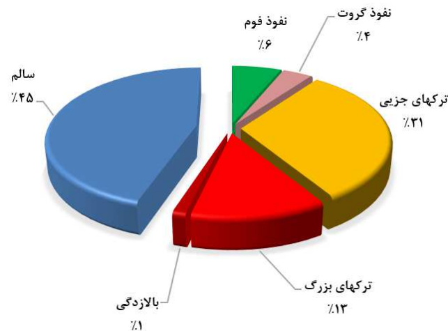
شکل ۱۶. درصد آسیب‌های ناشی از حفار تونل در زیر بافت فرسوده شهری در محدوده مورد مطالعه
