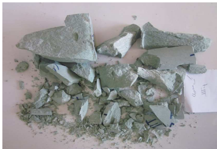
شکل ۳. نحوه شکست نمونه در آزمایش مقاومت تراکمی تک محوری
