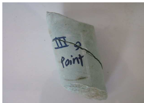
شکل ۵. نحوه شکست نمونه در آزمایش بار نقطه‌ای
