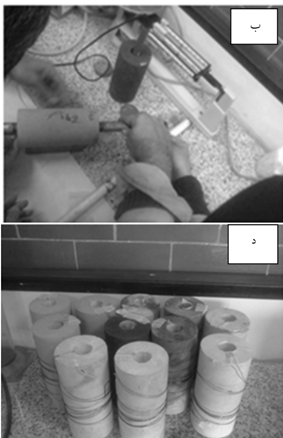
شکل 2. (الف) تصویری از نمونه‌های استوانه‌ای توخالی آماده‌شده، (ب)، (ج) و (د) مراحل نصب کرنش‌سنج بر روی دیواره‌ی گمانه حفرشده
