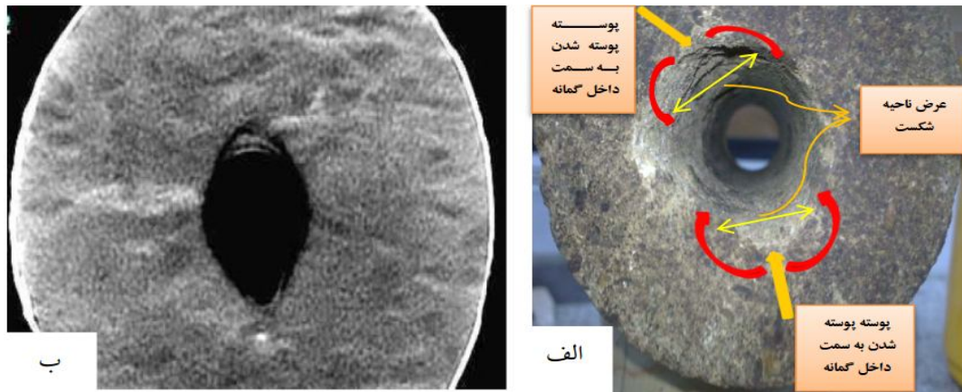
شکل 6. نحوه‌ی شکست در دیواره گمانه‌ی نمونه‌های ماسه‌سنگ: الف) در شرایط تنش محوری ثابت 5/5 مگاپاسکال و تنش جانبی متغیر (نتایج آزمایش) و ب) نتایج پاپامیکوس برای شرایط مشابه (Papamichos et al., 2004)
