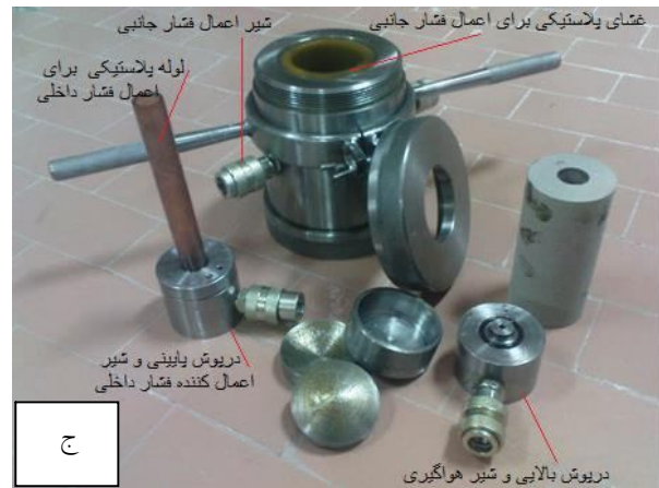
شکل 3. (الف) نمایی کلی از سلول هوک تغییر یافته، (ب) سلول هوک تغییر یافته با نمونه داخل آن در دید از بالا و (ج) اجزای داخلی سلول هوک
