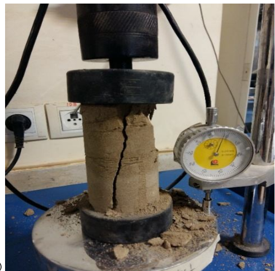
شکل ۲. تصویری از نمونه‌ها قبل و بعد از انجام آزمایش مقاومت فشاری تک محوری
