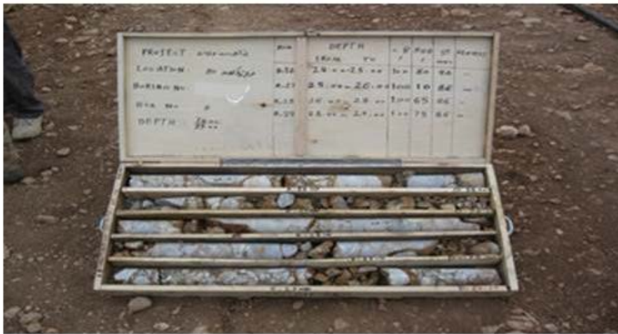
شکل ۱۰. وجود زون خردشدگی در عمق ۲۰-۲۵ گمانه شماره ۱۲
