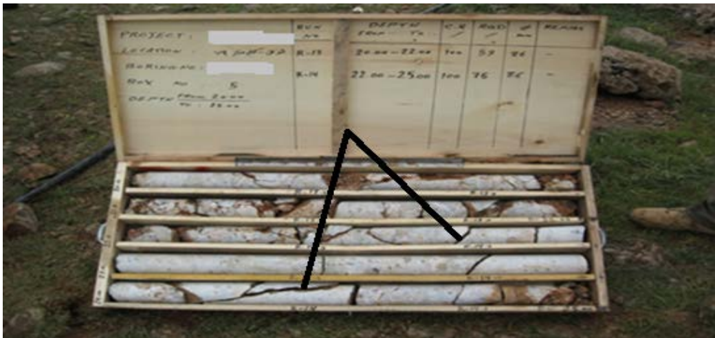
شکل ۷. تصویر جعبه مغزه مقطع ۲۵-۲۰ متری گمانه شماره ۴، درزه های ناشی از شکست هیدرولیکی با خط تیره مشخص شده.
