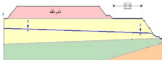
شکل ۳. هندسه فعلی دیواره معدن به همراه دامپ باطله در مقطع ۱۰۰۵۰۰ جنوبی
