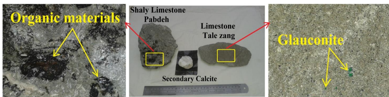
شکل ۱۳. وضعیت توده‌سنگ‌های آهکی (مصالح حفاری) در مرز سازندهای پابده و تله‌زنگ.
