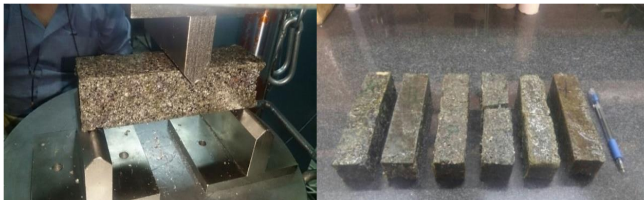
شکل ۷. سنگ مصنوعی ساخته شده در قالب خمش سه‌نقطه‌ای و فک‌های دستگاه خمش
