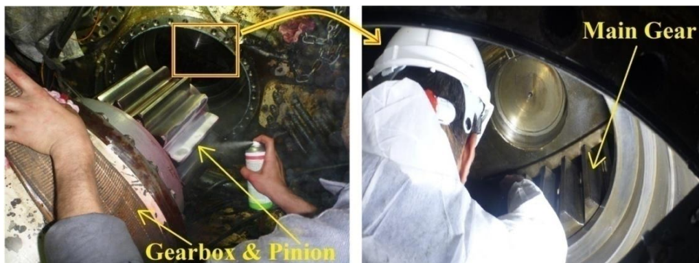
شکل ۱۶. محل اتصال چرخ‌دنده خروجی گیربکس‌ها به چرخ‌دنده یاتاقان اصلی*.
