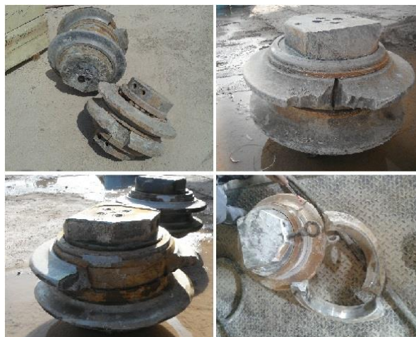
شکل ۶. شکستگی دیسک‌های برشی دوبل (دو تیغه).
